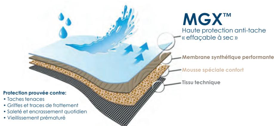
\*MGX de **Morbern®** ( MorGuard Xtreme™), est un vernis de finition anti-tâches hautement nettoyable. Mise au point à l'origine pour les besoins du marché de la construction nautique (où les revêtements étaient marqués durant la production), la finition MGX, qui protège le simili et facilite le nettoyage des tâches les plus difficiles (comme le rouge à lèvres, le café, la moutarde et le stylo à bille),
